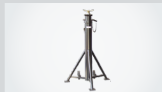
Abstützbock AB 6-20 / 7500 kg Verstellbereich 1200–1965 mm
